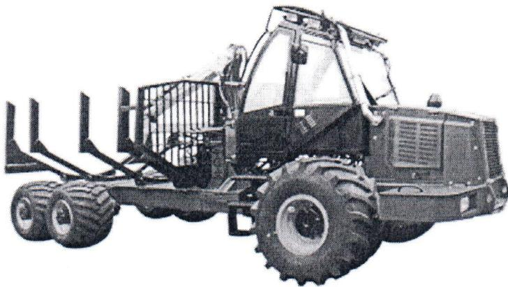
**Форвардер АМКОДОР 2631** предназначен для сбора, погрузки и транспортировки по территории лесосек, волокам и лесовозным дорогам сортиментов и других круглых лесоматериалов, трелевки, а также для выполнения погрузочно-разгрузочных работ, операций сортировки и складирования при выполнении рубок ухода за лесом и выборочных санитарных рубок.
